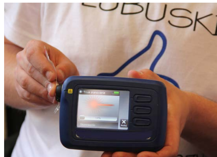
Spektrometr - urządzenie do szybkiego wykrywania dopalaczy
